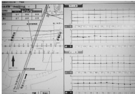
写真-5 軌道変状管理システム
