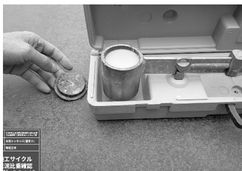
写真-4 泥水剤比重測定 (マッドバランス)
