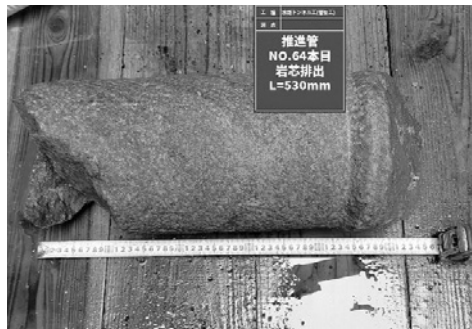
写真-7 破碎排土された岩盤 530mm
