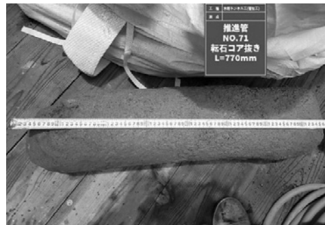
写真-8 破碎排土された岩盤 770mm
