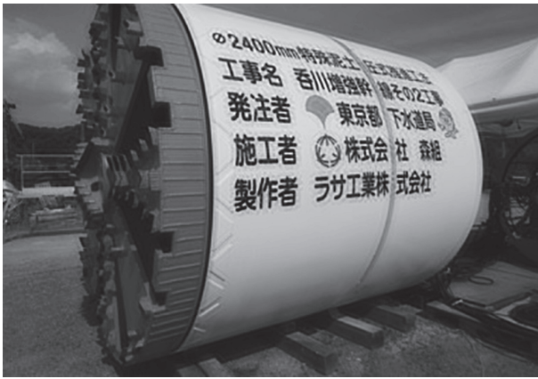
写真-1 掘進機外観
