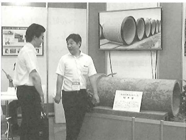
写真手前は50年ほど下水管として使われていた経年管。
